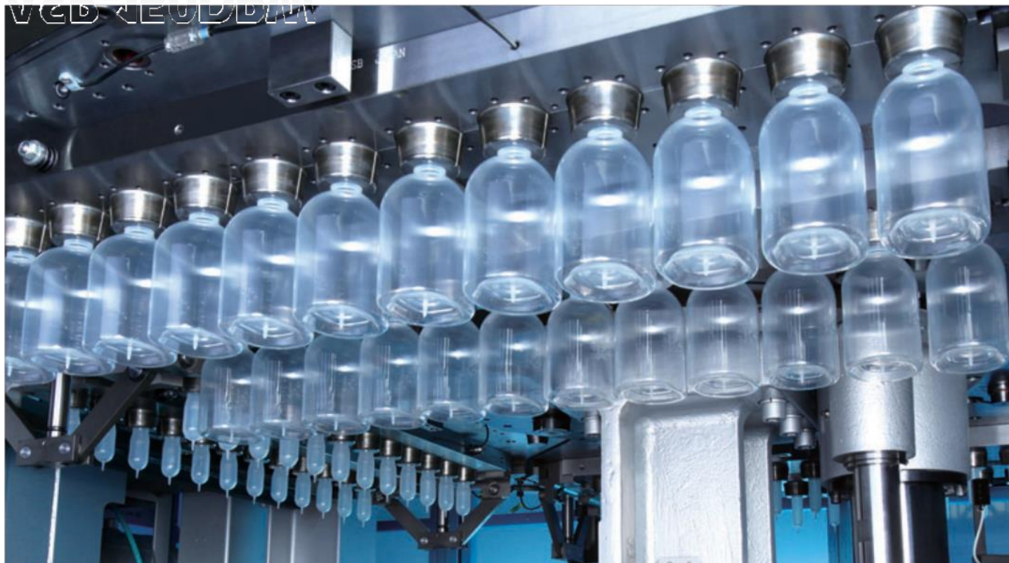
24 cavidades, frasco de infusão de polipropileno para aplicações médicas demonstra a versatilidade do ASB-150DPW.
